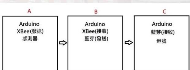
觸發 A 端的感測器後, A 端用 zigbee 訊號將訊息傳至 B 端, B 端再以藍牙訊號發送至 C 端, C 端亮起燈號已示收到訊號 補充:兩端之間可進行加密,如凱薩加密等
